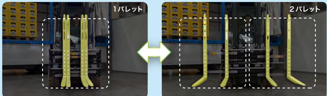
YAMAKAWA オリジナル・ワントーロードフォーク（フォークポジショナー機構搭載型）に加えて、海外でメジャーなスプリングダンパー機構搭載型のKAUP オリジナル・ダブルパレットハンドラーを新たにラインアップしました。
